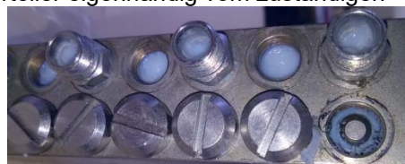
Abb. 2: Progressivverteiler vor Demontage
