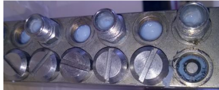
图 2: 拆卸前的渐进式分配器
