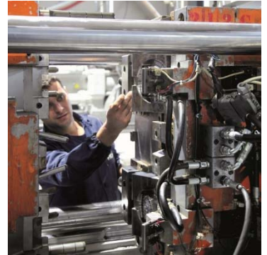
图：靠指尖感觉的润滑- 在 FILPLAST 公司的注塑机上应用
